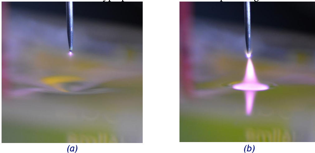
Figure 1. Photographie d'une décharge établie entre une pointe à une haute tension DC et un liquide à la masse : (a) décharge couronne et (b) décharge "luminescente"
